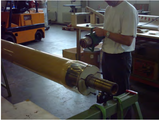
Vorbereitung, Walzenzapfen werden durch ein Stahlrohr verlängert
