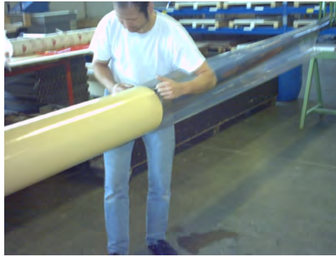
Schrumpfschlauch wird wie ein Strumpf über die Walze gezogen
