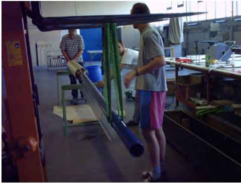
Vorbereitung, Walzenzapfen werden durch ein Stahlrohr verlängert
