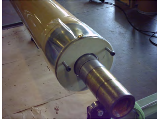
Schrumpfschlauch wird wie ein Strumpf über die Walze gezogen
